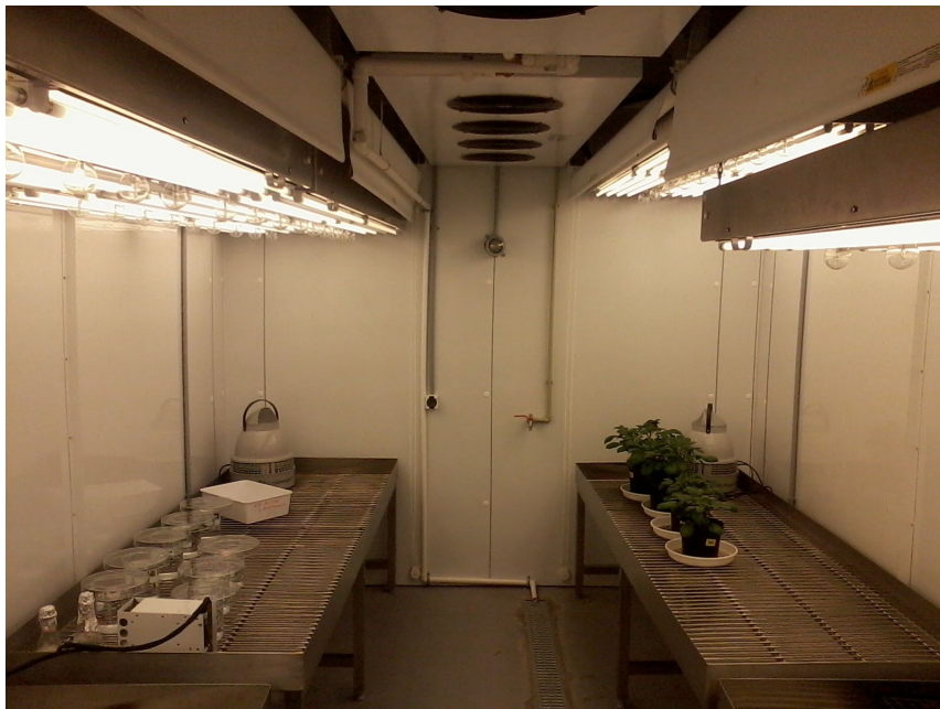
Ryc. 4. Pomieszczenie hodowlane – fitotron firmy CONVIRON model CMP 6050 (fot. A. Rybak, 2011).
