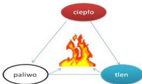
Rysunek 2. Trójkąt ognia – model spalania według Emmons (the fire triangle) [7].
