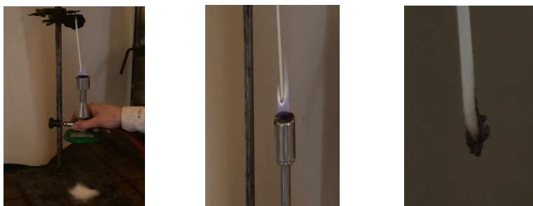
Fot. 2. Zachowanie się w płomieniu próbki polipropylenu uniepalnionego (podczas testu metodą UL94VB – badania własne autorów).
