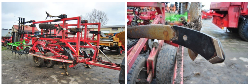
Rys. 3. Agregat Terrano 6FG firmy HORSCH a) podczas montażu narzędzi, b) radlica z kompozytową warstwą powierzchniową Stellite-6/WC
