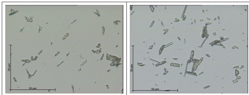
Fot.3. Mikrofotografia osadu fosfogipsu „Togo” (po lewej) i „Maroko” (po prawej)
