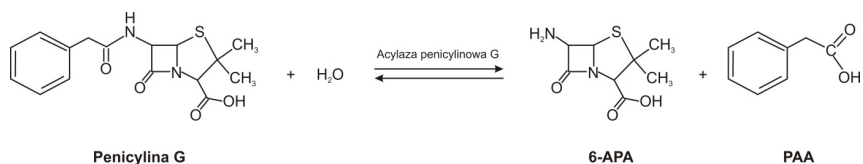
Rysunek 12. Reakcja hydrolizy penicyliny G w obecności acylazy penicylinowej G, PAA – kwas fenylaoctowy
