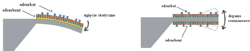
Rysunek 17. Statyczny i rezonansowy tryb pomiarowy z wykorzystaniem mikrobełki sprężystej[2]
