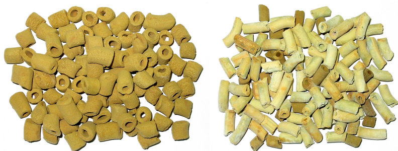
Rysunek 8. Katalizator niskooporowy w kształcie pierścieni Raschiga o różnych średnicach
