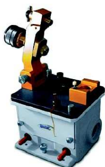
Rysunek 9. Zdjęcie i schemat działania przystawki Golden-Gate firmy Specac.
